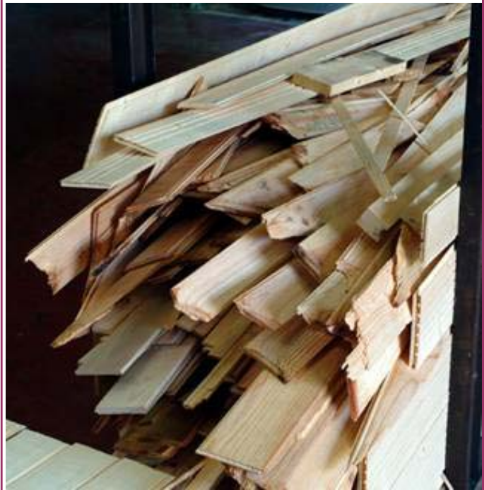
Les lambris non conformes sont recyclés en liteaux. (Crédit photo Jean-Paul Houdry/ADEME)
